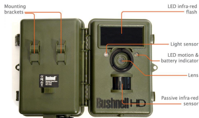
Figure 1: Présentation d'un piège photographique et ses composants (Diermer Vercayie, 2016, p.8)
